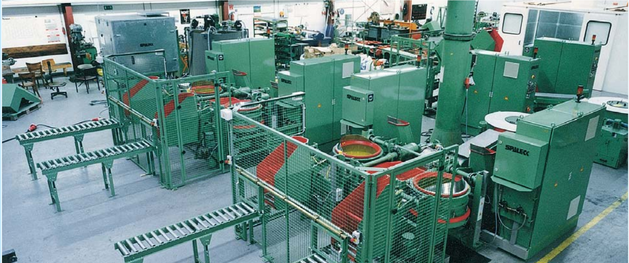
Großanlage (3 Tandem-Fliehkraft-Gleitschleifanlagen) zur Oberflächenbehandlung von Kettenteilen mit integriertem, vollautomatischem Recycling der Prozessflüssigkeit ohne Abwasser (1.800 l/Std.).
